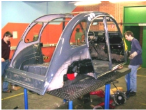
Bild 18: Die Karosserie war zu schweißen. Die Bodenplatte musste angepasst werden.
