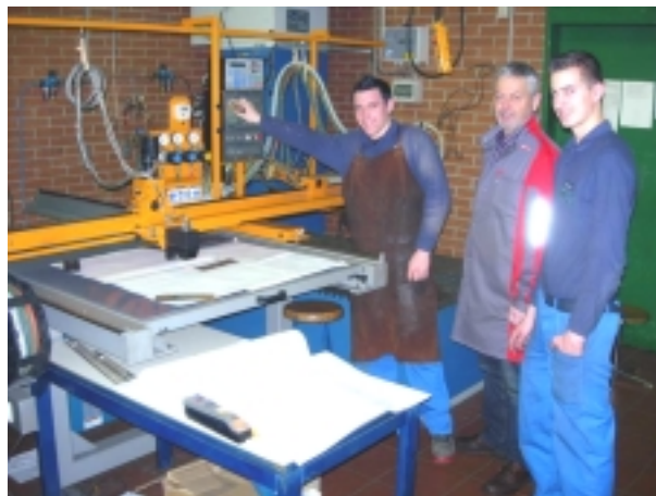
Bild 5: Die Bleche werden ausgeschnitten
