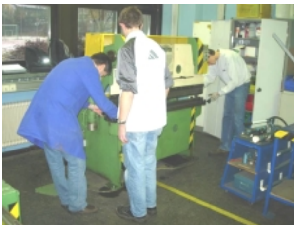
Bild 6: Die Bleche werden gekantet.
