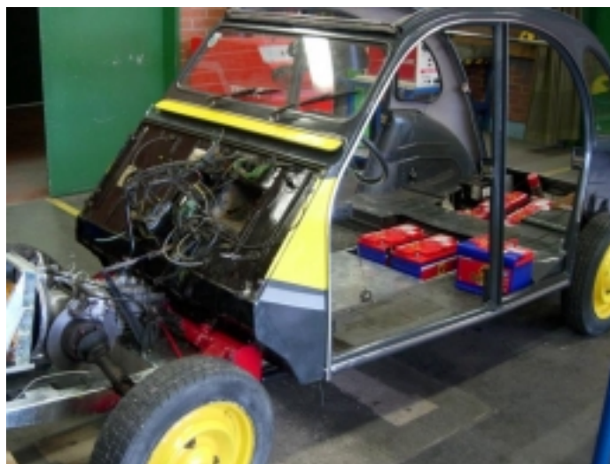
Bild 20: Die Batterien sind in der Bodenplatte eingebaut.
