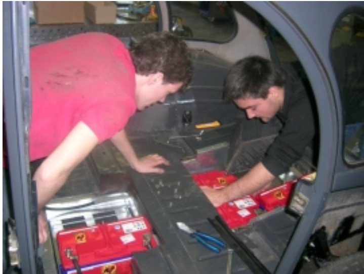
Bild 21: Im mittleren Fahrzeugbereich sind 2 Stk. Batterien untergebracht.
