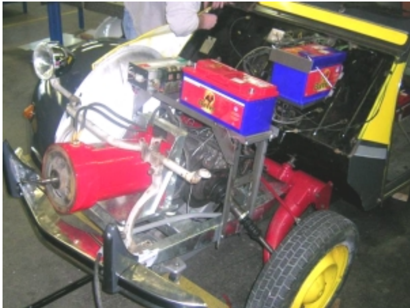
Bild 27: Das Originalgetriebe wurde beibehalten. Der Elektromotor wurde mit einer Klauenkupplung mit dem Motor verbunden.
