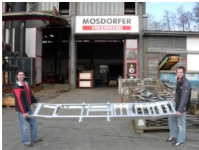
Bild 10: Der Rahmen (Bodenplatte) ist fertig verzinkt
