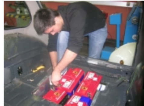
Bild 22: Im hinteren Fahrzeugbereich sind 4 Batterien untergebracht.
