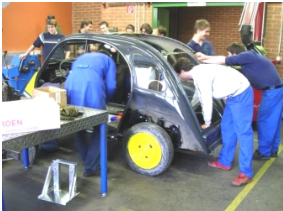
Bild 19: Sehr spannend ist das Aufsetzen der Karosserie auf die Bodenplatte.
