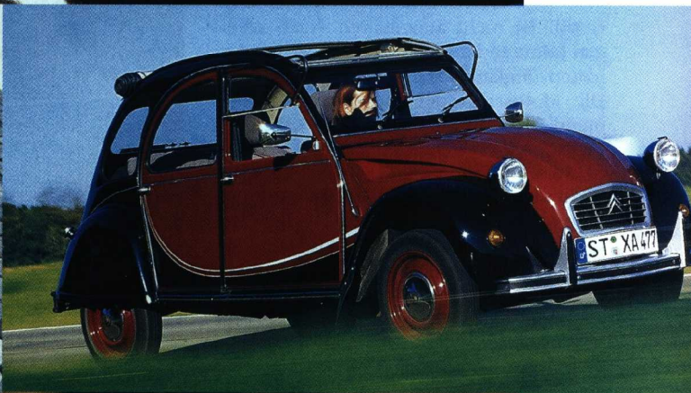
Der 597 cm 3 große Zweizylinder-Boxer leistet in der Charleston-Ente satte 29 PS. Trotz reichlichen 2400 Millimetern Radstand geht es in Kofferraum und Interieur des 2 CV ziemlich beengt zu
